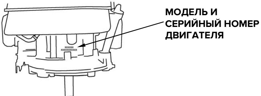
Запишите серийный номер двигателя в указанном ниже месте. Этот серийный номер вам понадобится при заказе деталей, а также при получении технической или гарантийной помощи.
