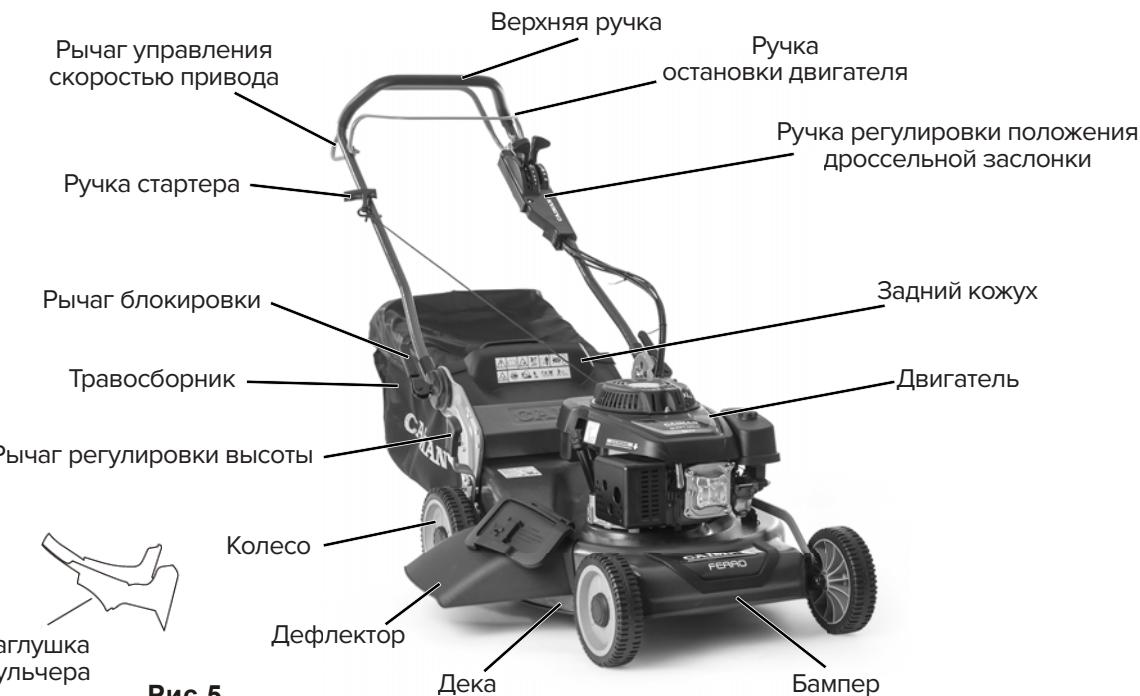
**Ручка регулировки положения дроссельной заслонкой** используется для запуска двигателя и позволяет выбрать либо быструю, либо медленную скорость работы. **Ручка стартера** используется для запуска двигателя.
