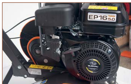
Двигатель Robin-Subaru EP16 с верхним расположением распределительного вала
