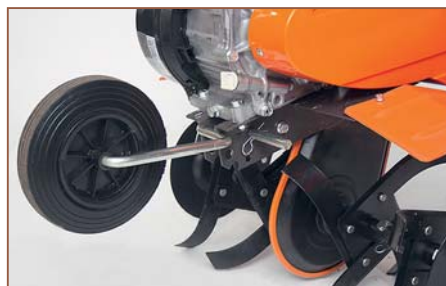
Переднее транспортировочное колесо с узлом крепления. Для изменения положения колеса надо вынуть шплинт, немного сдвинуть колёсную опору вбок, установить в нужном положении и снова зафиксировать шплинтом
