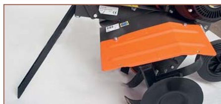
Боковые съёмные крылья, необходимые при работе двумя парами фрез, и не регулируемый по глубине захода в землю сошник
