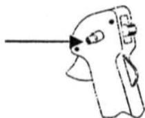
2. Нажимайте на нагнетатель, расположенный под карбюратором, 4–5 раз, чтобы топливо попало в прозрачный топливопровод.
