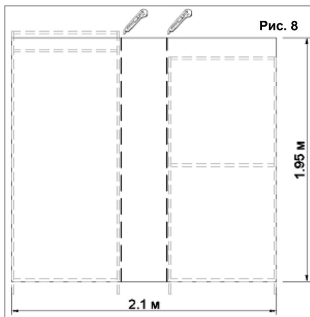
3. Другой лист поликарбоната размером 1,95x2,10 м прикрутите к передней стенке каркаса, выровняв по одному из краев. Затем обрежьте по другому краю. Прикрутите петли и завертки саморезами 4,2x19 мм и прорежьте дверь (рис. 8).
