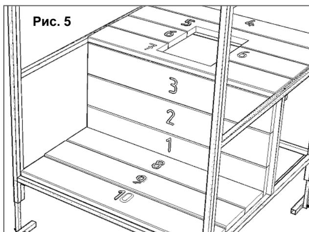
5. С помощью саморезов 4,2x41 мм прикрутите доски к каркасу в последовательности, указанной на рис. 5.
