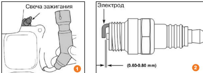
Для проверки свечи зажигания сделайте следующее:
